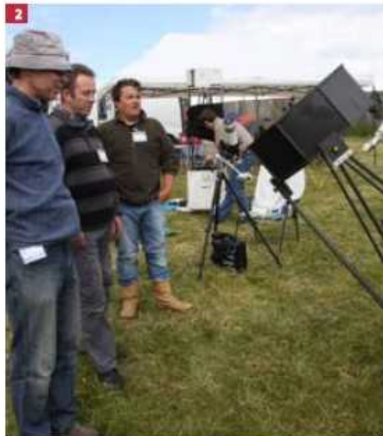
2 Un télescope ultra léger fabriqué en fibre de carbone. Photos Jean-Paul Bert
