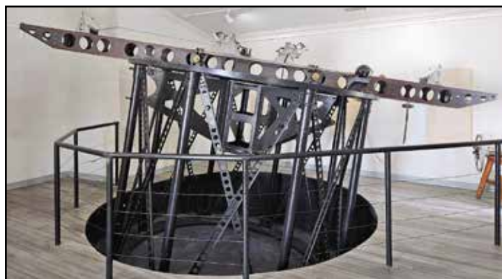
Interféromètre périscopique tel qu'il pouvait être placé sur le haut du télescope Hooker, la poutre transversale fait 7,6 mètres de long. Source Wikipedia
