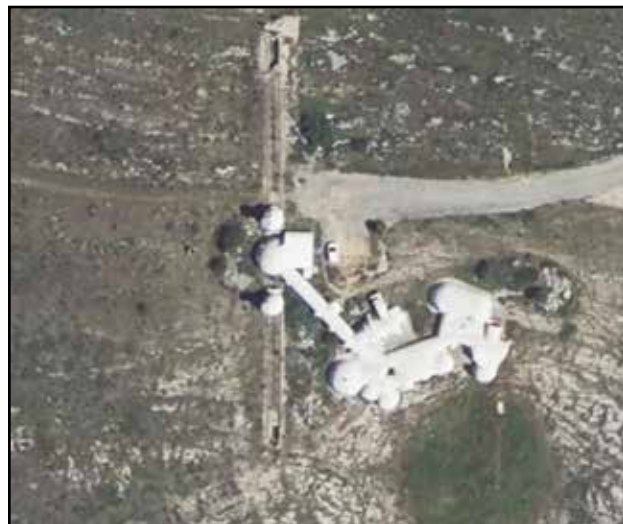
Vue aérienne du GI2T sur le plateau de Calern. Il s'agit de la deuxième réalisation d'Antoine Labeyrie. On remarque bien les rails permettant un espacement de 65 mètres sur lesquels les deux télescopes de 1,5 mètres coulissent. On voit également le laboratoire focal situé entre les deux boules des télescopes.
