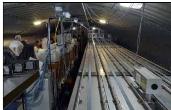
Lignes de retard situées dans le laboratoire focal de COAST. Les chariots se déplacent le long des rails pour que chaque ligne optique conserve la même distance et permette d'obtenir des franges d'interférométries. Source Wikipedia
