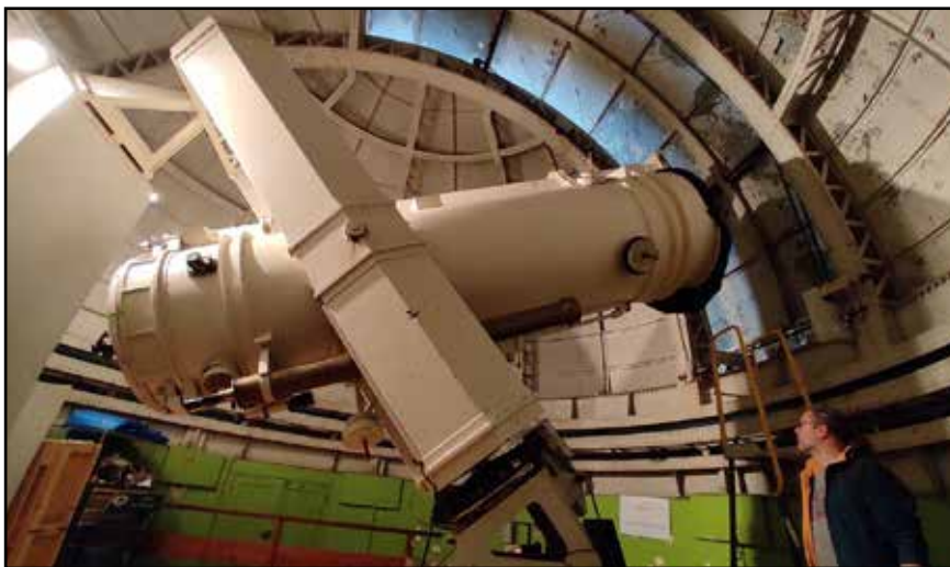
Le télescope d'un mètre de diamètre, presque à l'étroit sous sa coupole
